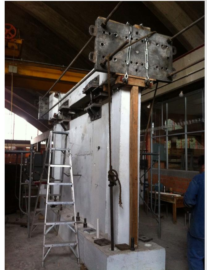
Pórtico ensayado en la UNAM para estudio de conexiones.
